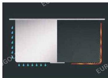
Được phủ lớp sơn chống thấm ngược hạn chế hiện tượng ngưng tụ nước, an toàn cho tủ bếp
